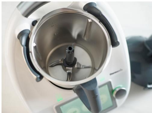
**2** Setze die Achse auf das Thermomix® Mixmesser im Mixtopf und vergewissere dich, dass sie richtig platziert ist. Bringe die Achse in der Mitte des Mixmessers an, sodass die Achse senkrecht steht.
